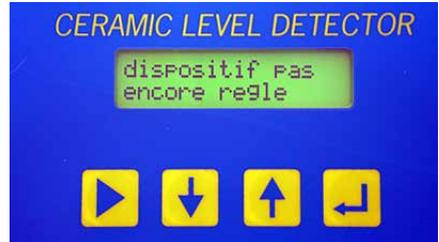
Positionner le capteur dans le réservoir et procéder au remplissage (p.ex. en actionnant manuellement le mécanisme de l'électrovanne) jusqu'au niveau maximum possible, dans la limite de 2 mètres. Le remplissage peut se faire sans limite de temps, même sur plusieurs heures. *Attention : pour une précision maximale de l'appareil, il est nécessaire d'avoir une hauteur minimale d'eau de 50 centimètres.*
